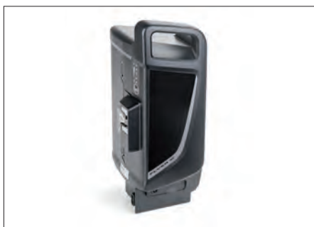
Li-Ion-Mangan-Akku 15 Ah / 36 V (540 Wh) Kompatibel mit allen FLYER Flogo-Modellen ab Modelljahr 2015. 3.8 kg; 13 x 11.2 x 28.5 cm CHF 1199
