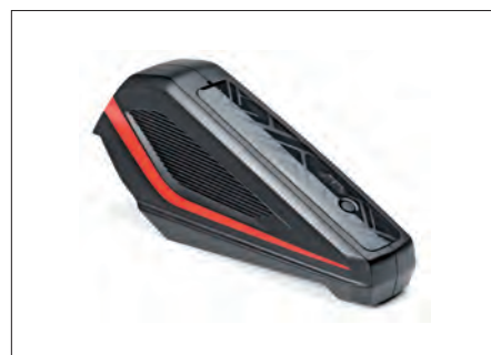
Li-Ion-Mangan-Akku 8.8 Ah / 48 V (422 Wh) Kompatibel mit allen FLYER vollblut-Modellen ab Modelljahr 2013. 2.85 kg; 36 x 8.5 x 16.7 cm CHF 999
