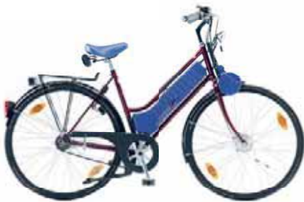
1992 Diamant Cityblitz Modell 784, Leichtmofa Rahmenmaterial: von Hand gelöteter Chrom-Molybdän-Stahlrahmen
