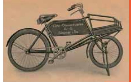
1934 Speziell für Lieferanten entwickelt Diamant in den 30er Jahren das berühmte Lieferrad mit großem verstellbarem Gepäckgitter über dem Vorderrad.
