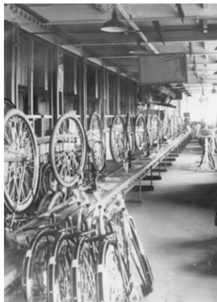
1950 Ab Januar arbeiten die Fahrradmonteure nicht mehr an Montageböcken sondern am Fließband.
