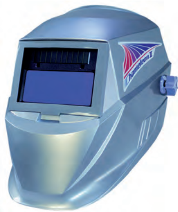
Casque de soudage Chameleon II ISO classe de protection DIN 4, enclenchement et déclenchement automatiques de la cassette anti-éblouissement 3026382 Fr. 245.-
